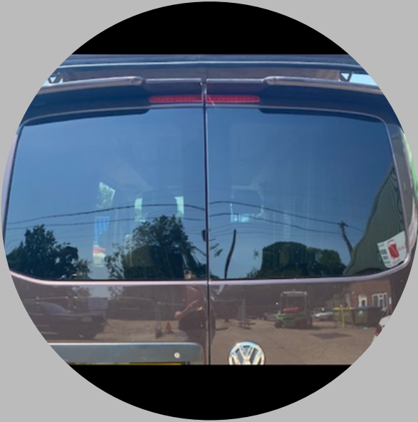
Barn door rear windows
